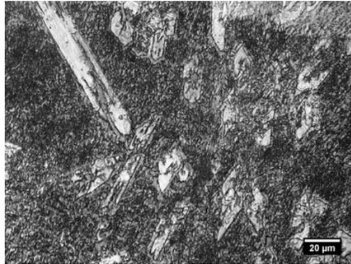
**Figura 1.** Microestructura del depósito sin dilución
