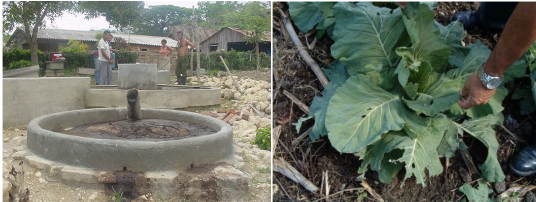
Figura 1. Planta de biogás en operación, se muestra la salida del efluente que es utilizado como biofertilizante en la finca
