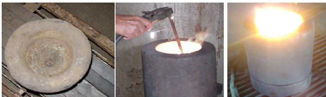
**Figura 1.** Reactor de grafito empleado para el procesamiento aluminotérmico
