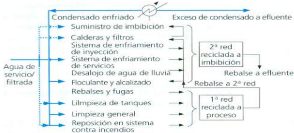
**Figura 3.** Sistema de manejo de agua en fábrica para permitir que únicamente el condensado sea descargado como excedente. (Jensen y Schumann, 2001)
