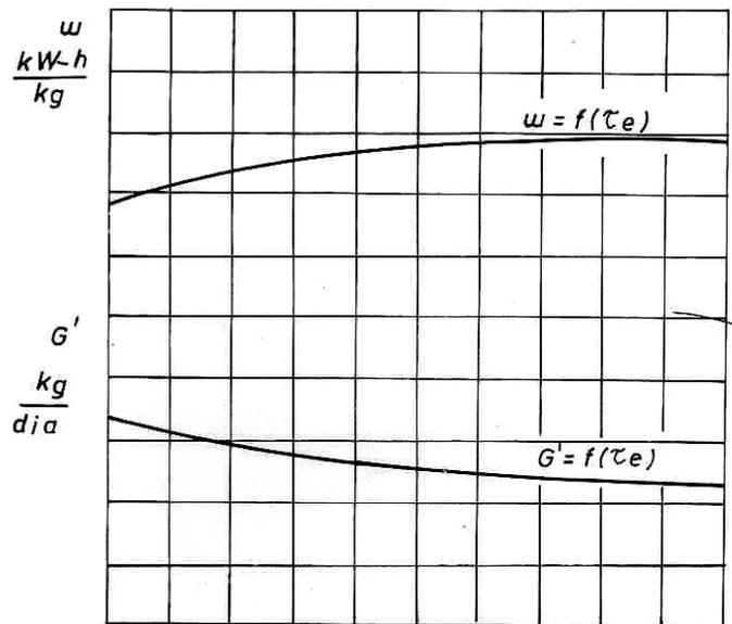
**Figura 2.** Dependencias del consumo específico de energía en kW – hr/kg y de la entrega de aire comprimido en kg/día del compresor
