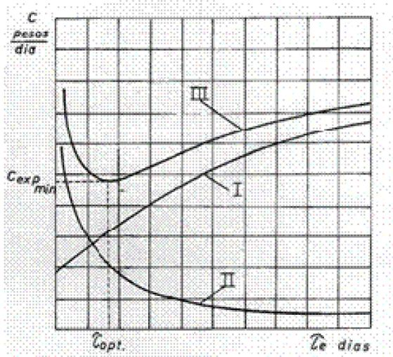
**Figura 1.** Determinación del período óptimo de limpieza de los enfriadores intermedios de un compresor centrífugo utilizando el criterio del Costo Mínimo
