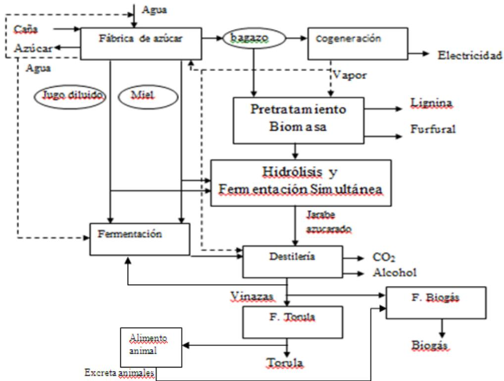
**Figura 1.** Esquema de biorefinería a partir de caña de azúcar
