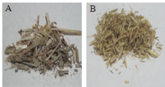
Fig. 2. Residuos de la agroindustria azucarera. A: paja de caña, B: bagazo de caña
