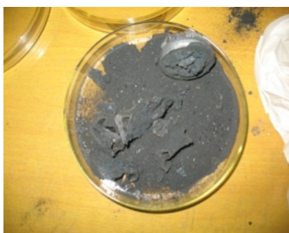
Figura 1. Metal y escoria producidos (fuente propia)
