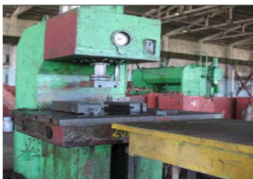
Figura 3. Prensa para el enderezado de las piezas
