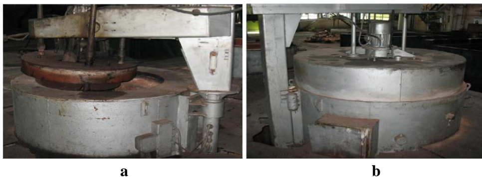
Figura 2. Hornos utilizados para el tratamiento térmico. a) Horno de temple, b) Horno de revenido
