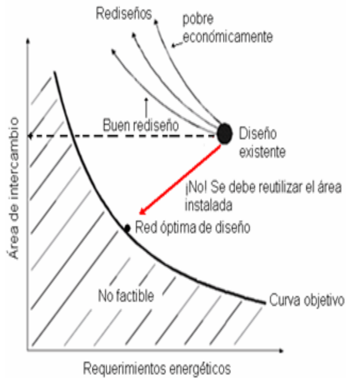
Figura 4. Diferentes caminos para el rediseño de una red de intercambio de calor
