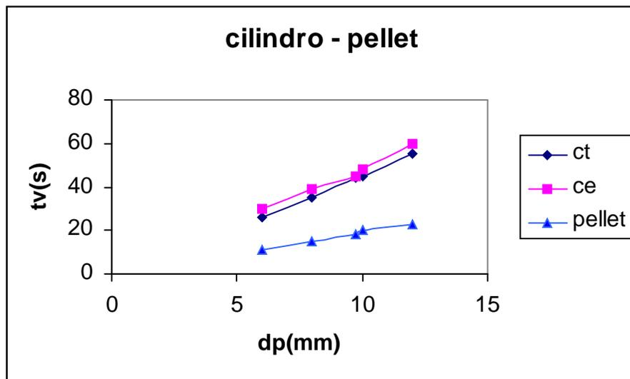
Se compararon los tiempos obtenidos para pellets compactados de aserrín de pino y muestras cilíndricas obtenidas de varillas de pino, usando la correlación dada por la
