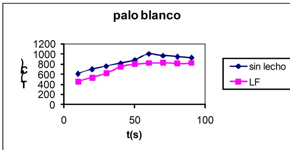
**Fig. No. 3:** Evoluciones térmicas en muestras de Palo blanco en función del tiempo con y sin lecho
