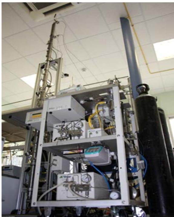
**Figura 2.** Equipo de extracción supercrítica
