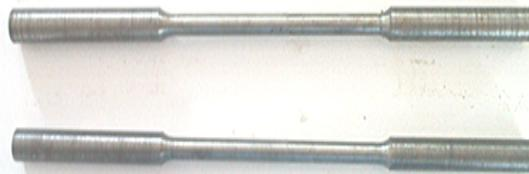
Figura 8. Probetas maquinadas con las dimensiones establecidas
