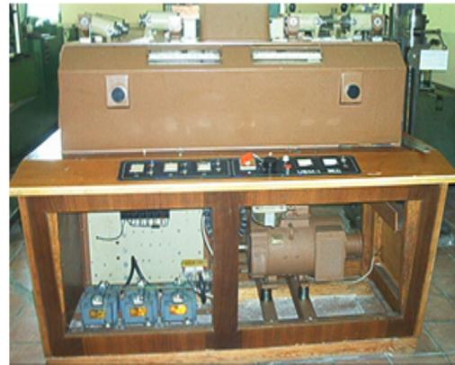
**Figura 2. Máquina de ensayo de fatiga a flexión rotativa UBM – 1**
