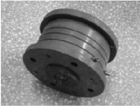
Figura 7 Molde para engranaje plástico asimétrico de perfil recto fabricado.
