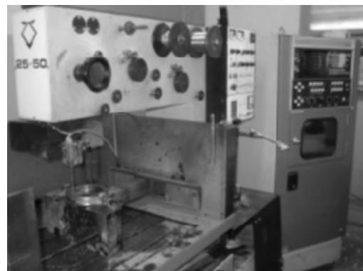
Figura 6 Máquina Electro - erosiva de Hilo durante el proceso de fabricación de la cavidad para un molde de un engranaje plástico asimétrico.
