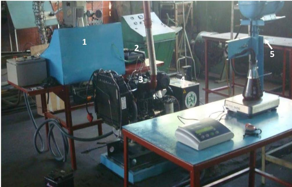
**Figura 1.** Instalación experimental (1-Panel de control, 2- Analizador de gases, 3-Motor, 4- Generador, 5-Resistencias)
