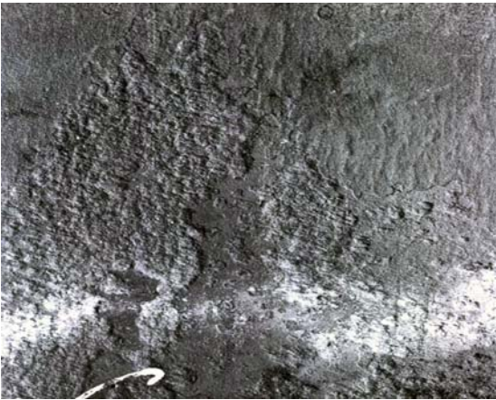
Fig. 5. Superficie que presenta una chapa de 20 mm de espesor de acero CrNiMo. Pueden observarse, después de un chorreado, las marcas dejadas por la eliminación de la cascarilla incrustada durante la laminación
