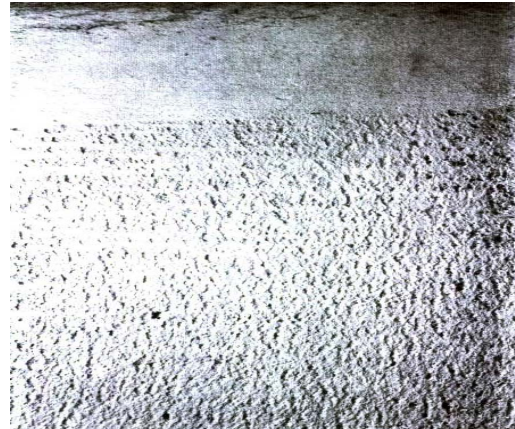
Fig. 6. Trozo de chapa de 12 mm de espesor de acero al CrMnMo (C = 0.20 ; Mn = 1.25 ; Mo = 0.25), mostrando la diferencia de calidad superficial entre una zona con cascarilla incrustada y otra libre de ella. El material ha sido decapado.
