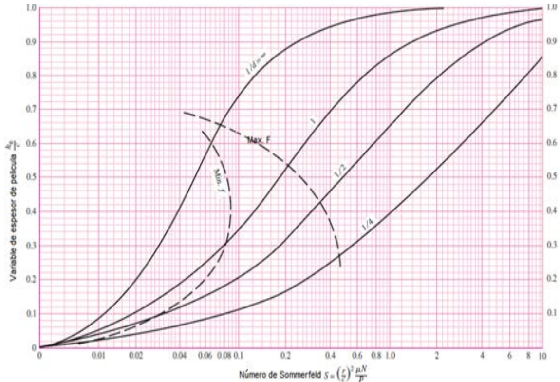
Figura 2. Variable h_0/c en función del número de Sommerfeld Fuente: (Budynas y Nisbett, 2008)
