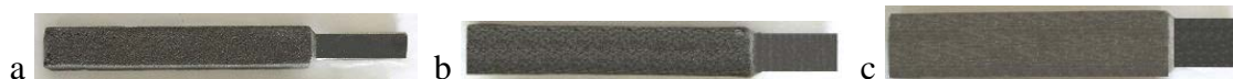
Figura 1. Electrodo revestido con núcleos de sección rectangular: a) Núcleo de 10 mm de ancho, b) Núcleo de 15 mm de ancho, c) Núcleo de 20 mm de ancho
