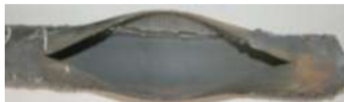
Figura 1. Tubo averiado por termofluencia en la termoeléctrica de Cienfuegos
