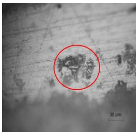
Figura 5. Disolución local de la matriz en torno a un grupo de PIM en la aleación 3004
