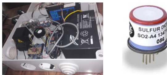
Figura 3. Prototipo HZS-GARP-AQ-03 y sensor electroquímico Alphasense SO 2 -A4
