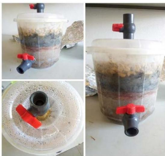
**Figura 1.** Biorreactor anaeróbico
