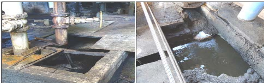
Figura 2. Residuales resultantes del proceso de producción en (tachos y calderas) (PC1)
