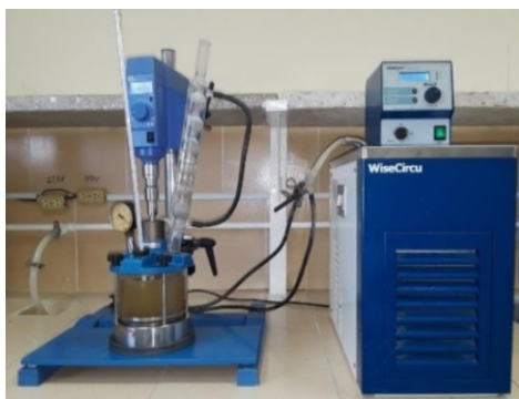
Figura 1. Instalación experimental utilizada a nivel de laboratorio en la hidrólisis enzimática de la sacarosa para determinar los valores de K' si y la relación K'/k de la ecuación de Yoshino y Murakami, (2009)
