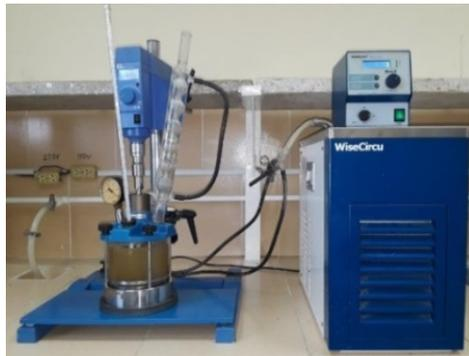
**Figura 1.** Instalación experimental utilizada a nivel de laboratorio en la hidrólisis enzimática de la sacarosa para determinar los valores de  $K'$  si y la relación  $K'/k$  de la ecuación de Yoshino & Murakami, (2009)
