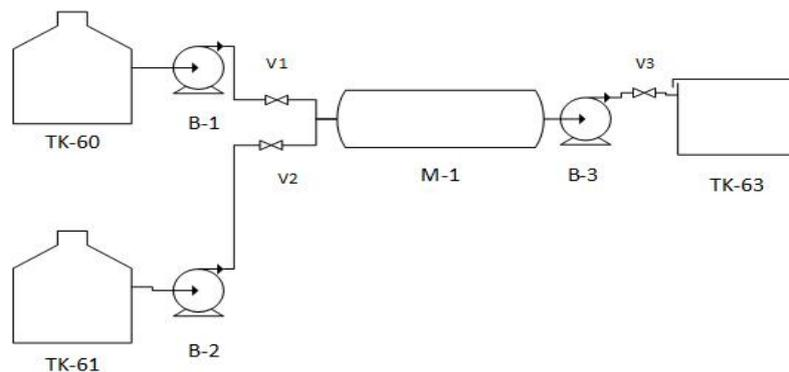
**Figura 1.** Modificaciones del esquema de la planta de destilación atmosférica con el sistema de mezclado incorporado
