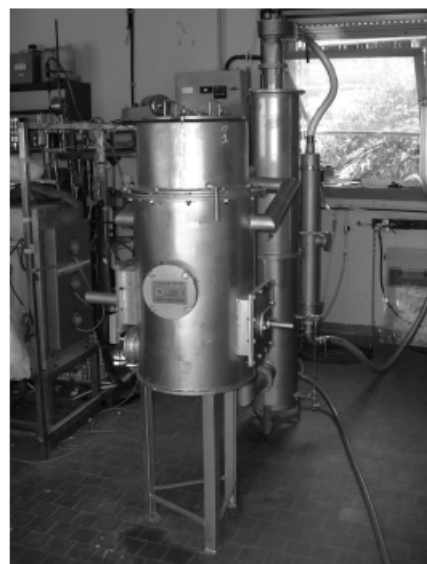
Figura 1. Gasificador y sistema de lavado del gas
